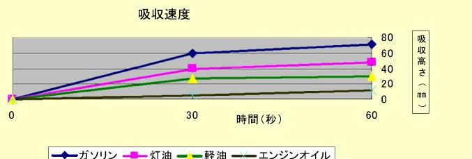
試験方法：10φのガラス管に流出油処理材を150mm高さまで充填し、吸収する高さを時間計測した。
