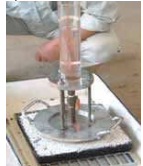
現場透水性試験装置にて試験
